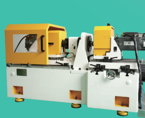
谐波减速器性能测试台
